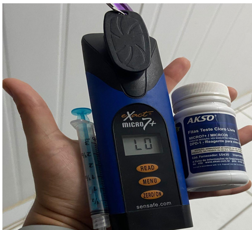
Figura 5 – Medidor de Cl e pH da água dos reservatórios.
