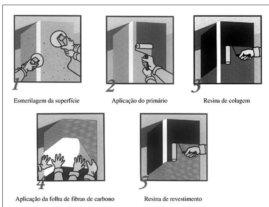
Figura 5: Sistema de aplicação das folhas flexíveis de CFRP.
