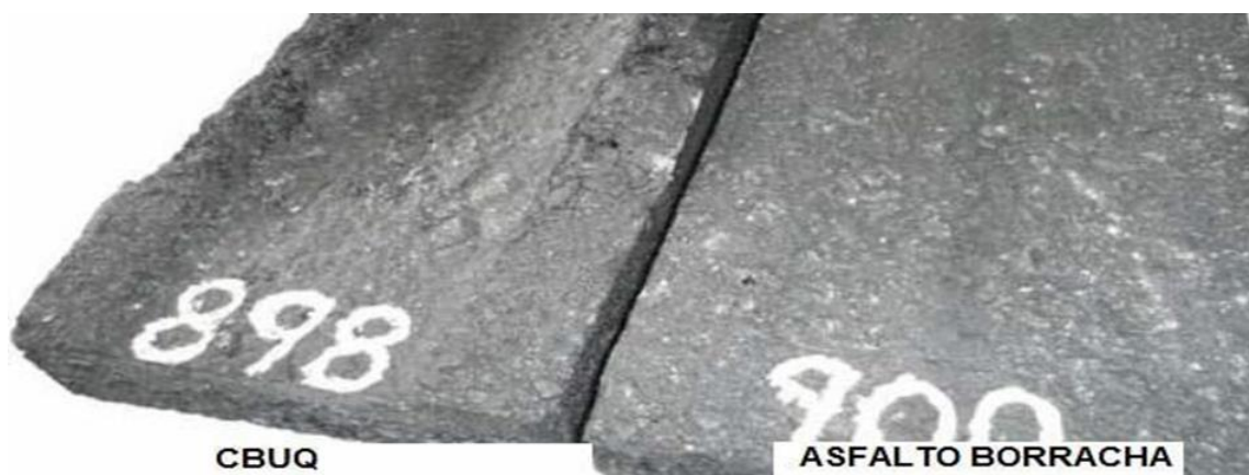
Figura 25 - Comparação entre revestimentos asfálticos após experimento com o uso das misturas asfálticas
