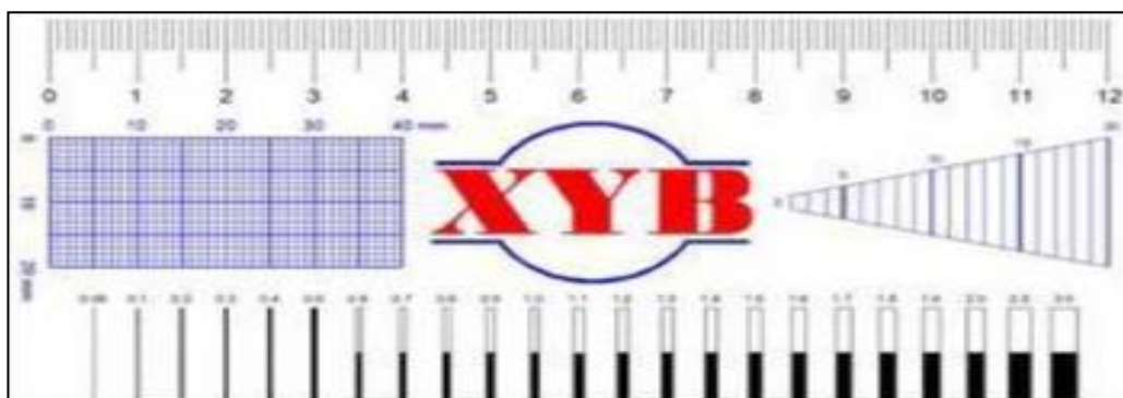
Figura 6 – Régua de fissura
