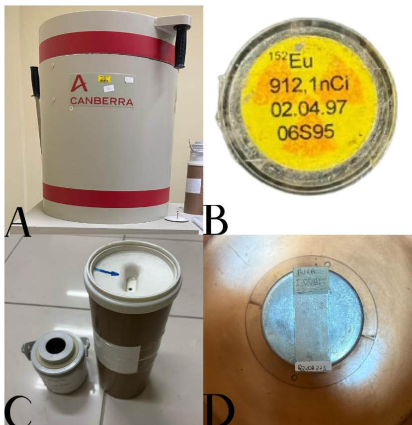
A) Detector gama; B) Fonte Eu – 152; C) Castelo de chumbo e plataforma cilíndrica; D) Amostra posicionada sobre o detector de germânio puro.
