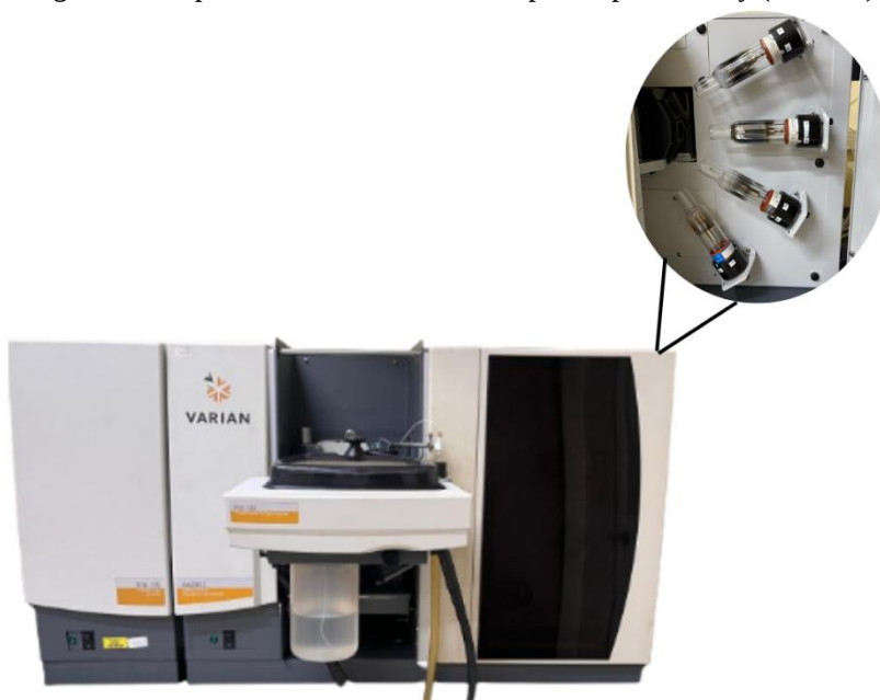
Figura 3 - Espectrometria de Absorção Atômica com Forno de Grafite (GFAAS) Figure 3 - Graphite Furnace Atomic Absorption Spectrometry (GFAAS)
