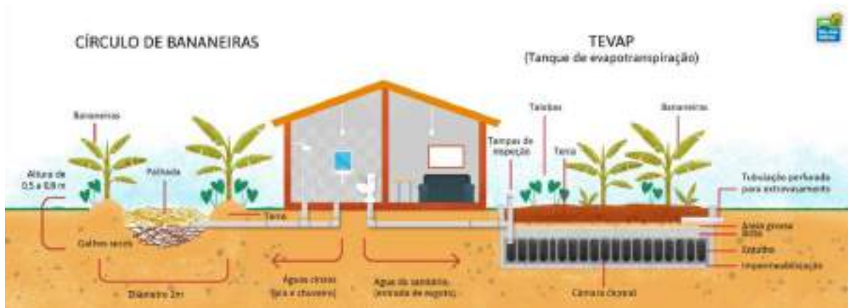
Figura 60: Tanque de evapotranspiração (TEvap)
