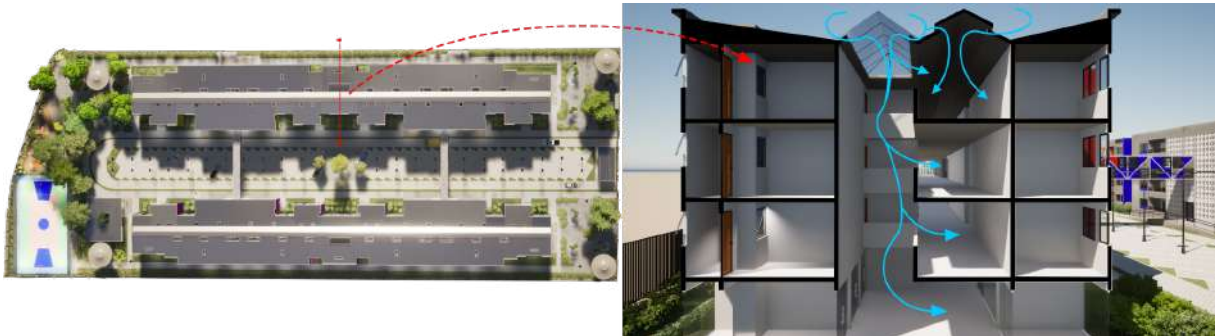
Figura 45: Corte transversal 1 do HIS para ventilação natural.
