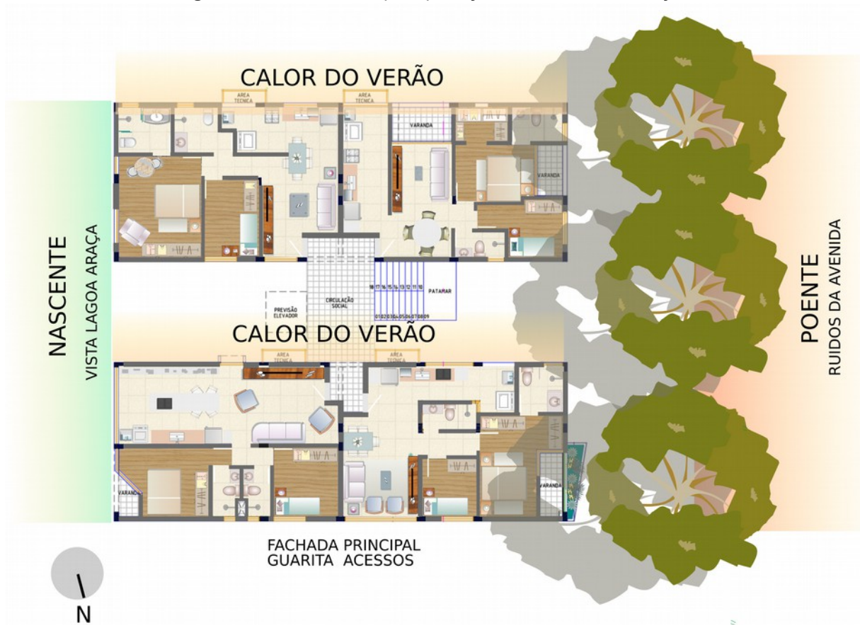
Figura 37 – Pavimento tipo e proteção solar com Arborização
