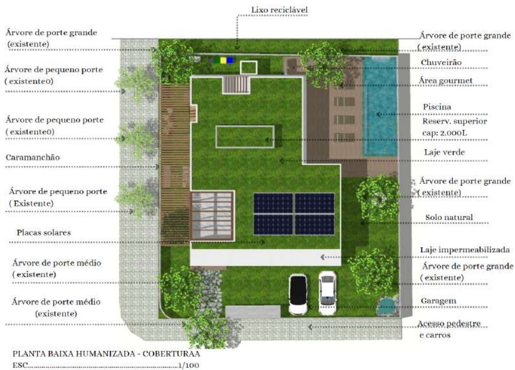
Figura 52 - Planta humanizada vista superior
