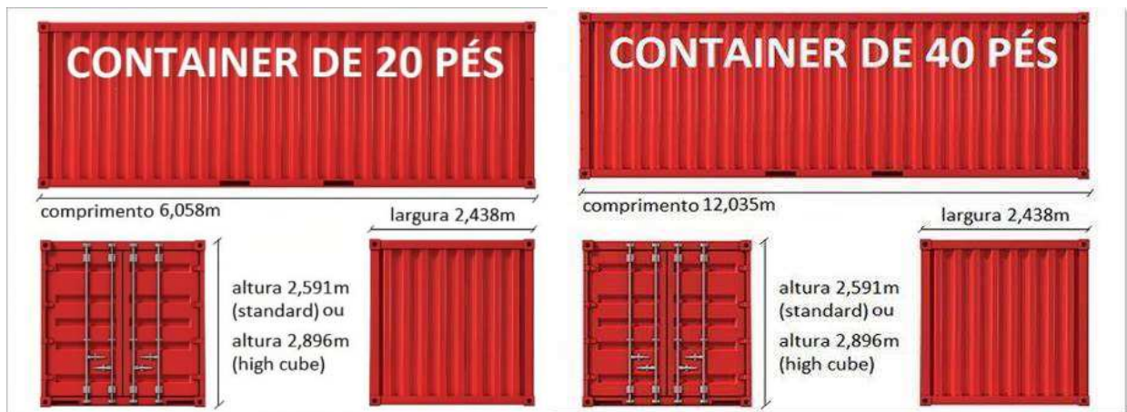
Figura 13 - Dimensões de contêineres 20 e 40 pés
