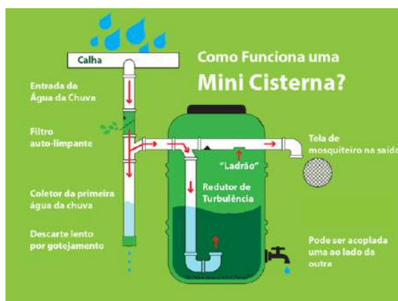
Figura 9: Funcionamento de cisterna.
