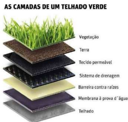
Figura 6: Esquema de aplicação para um telhado verde.
